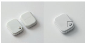
Ryc. 1 Sensor WARMIE z oznaczoną sondą przetwornika temperatury
